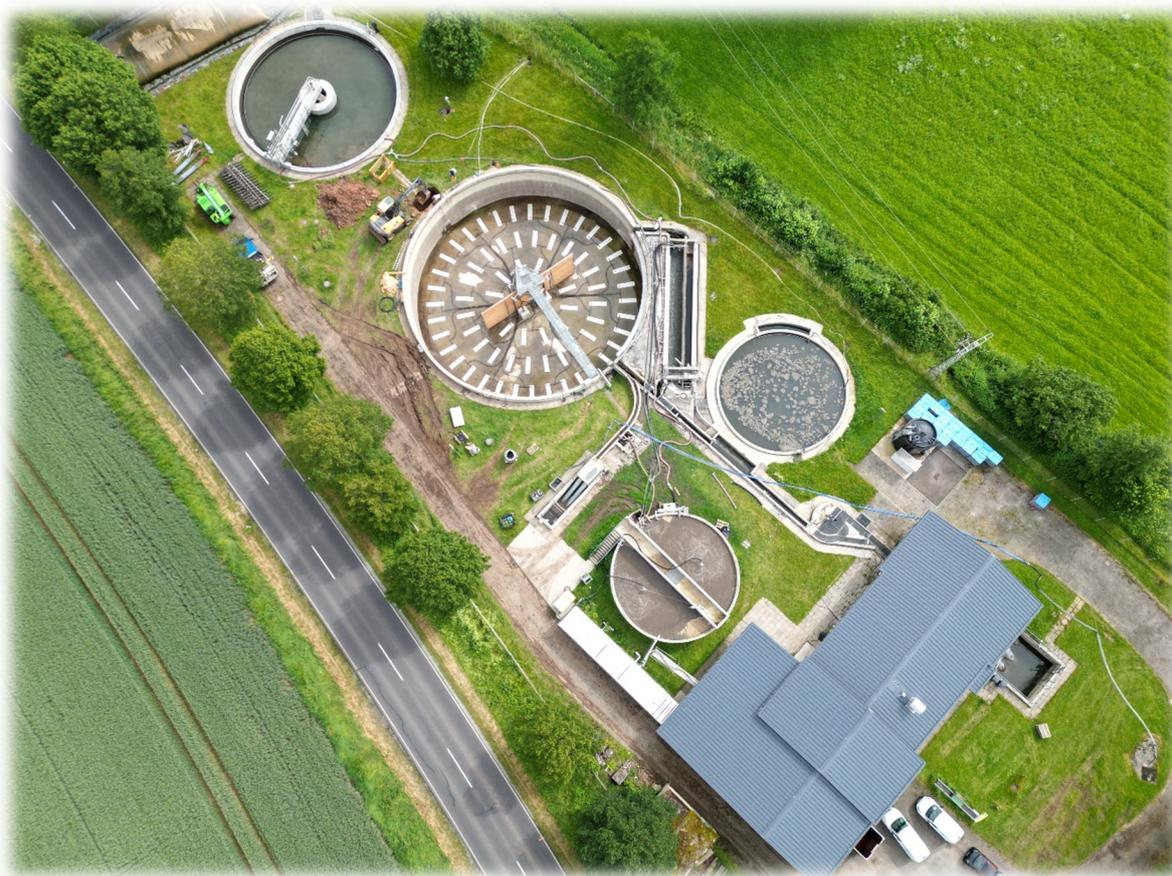
Auf diesem Bild sind die ab 2024 neuen Belüftungsmatten im Hauptklärbecken zu sehen. Diese bringen durch eine energieeffiziente Belüftung eine Energieeinsparung im Regelbetrieb.
